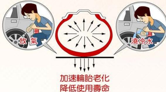
3. 定時檢查輪胎：平日或出門前做好輪胎的檢查，像是檢查輪胎的外觀，包含胎面、胎肩、胎邊是否出現外傷、變形、裂痕、龜裂、老化等情形，以及輪胎的胎紋深度是否足夠，都能降低爆胎的風險。
