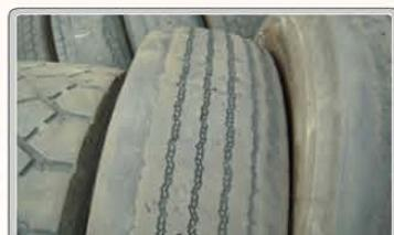
2. 輪胎充氣過高：輪胎充氣過高，胎體簾線張力增大，特別是在過量充氣，又超載超速行駛時，更增加了簾線的內應力，胎溫快速上升，橡膠老化速度加快，從而引發爆胎。
