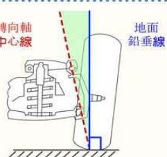
由車輛前方觀看轉向軸中心線與垂直地面的鉛垂線之間的角度。
