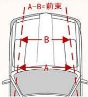
由車輛上方角度觀看車輪與行進方向形成的夾角，輪胎後端距離A減掉輪胎前端距離B，即為前束。
