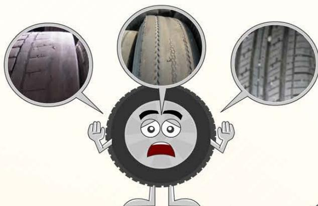
4. 超速：速度越快，越加速輪胎磨耗，且因加速輪胎屈伸活動也會增加，也增加了輪胎的發熱量，導致降低輪胎強度。
