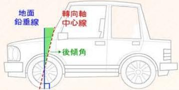
由車輛側面觀看，轉向軸中心線向後與垂直地面的鉛垂線之間的角度。
