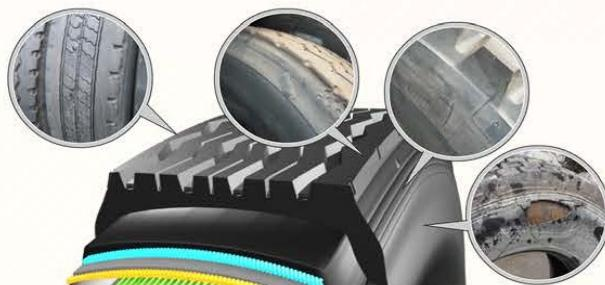
4. 嚴禁超速行駛：輪胎有一種「駐波」現象，常出現在超速行駛時，這種現象會使胎溫迅速升高，加速橡膠的老化，使其容易產生脫層和爆裂，導致爆胎，所以駕駛人應避免超速行駛。
