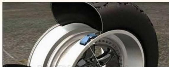
1. 原理：間接式的胎壓監測系統是透過汽車ABS系統測量輪胎的旋轉速度，同時偵測是否有胎壓異常的情形。
